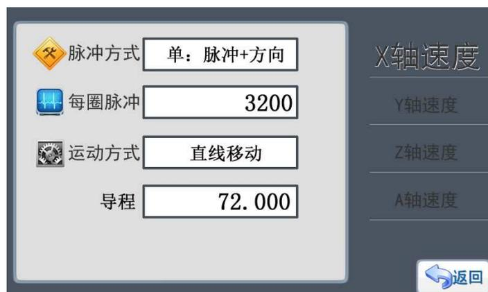
图 17 X轴电机设置
